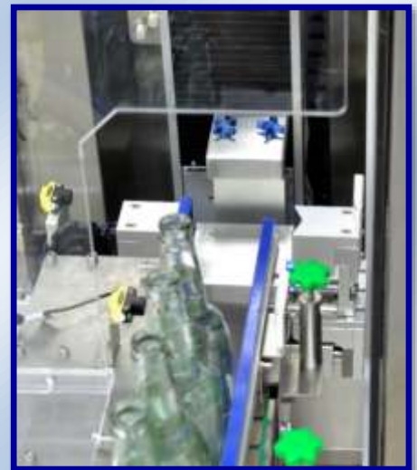
Detección automática de la muestra y sistema de retorno.
