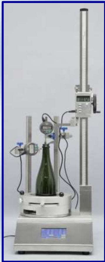
UBPT-3 con 3 cabezales de medición (para boca, perpendicularidad y altura) y doble calculador integrado
