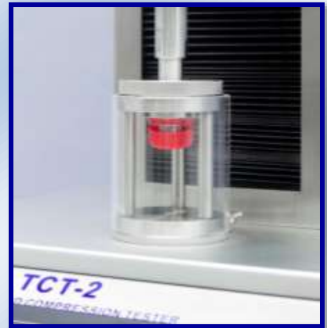
TCT-2 para prueba de rotura de banda de evidencia de manipulación (con accesorio opcional)
