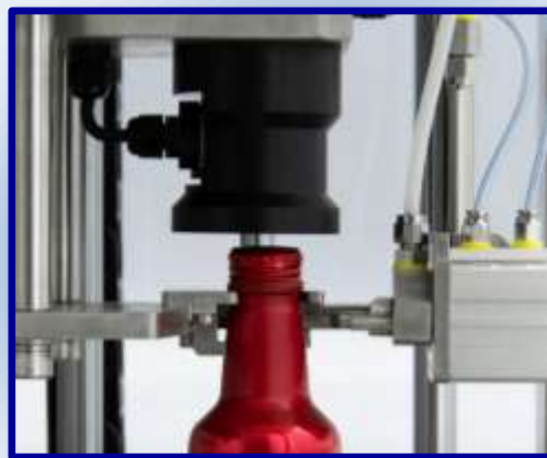
SSA-PLUS-P Solución para perforaciones en el cuello : las microfugas también se pueden detectar con precisión
