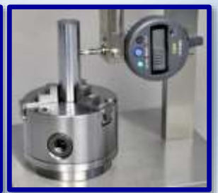
Columna de verificación
