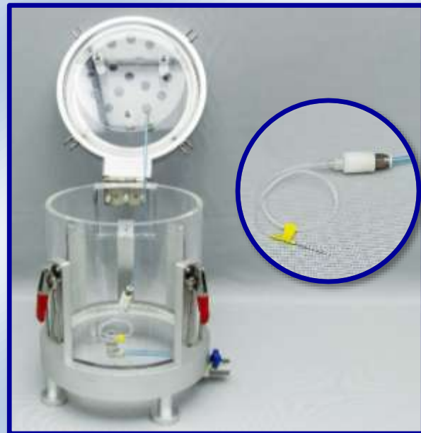
Caja de presión y vacío con pequeña aguja de perforación
