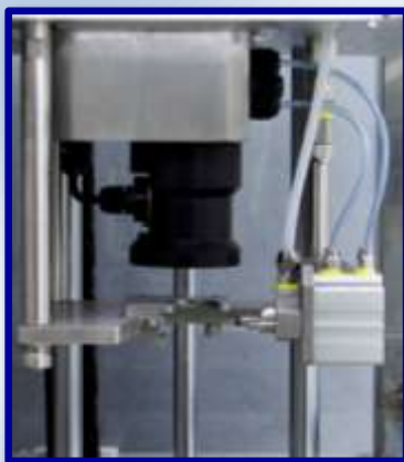
SSA-PLUS-P Solución para perforaciones en el cuello : las microfugas también se pueden detectar con precisión
