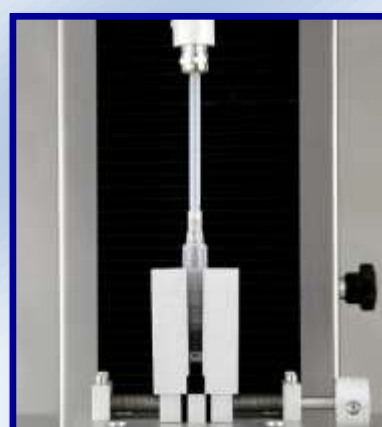
Prueba de remoción del tubo
