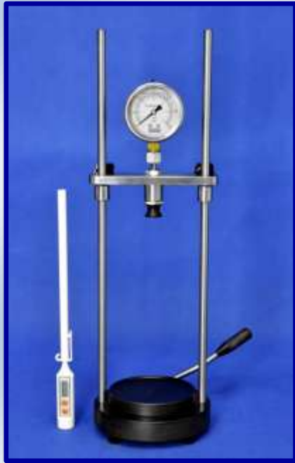
CO 2 Easy con manómetro analógico y termómetro
