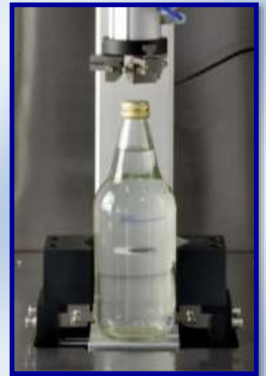
Sistema automático de sujeción / abrazadera personalizable
