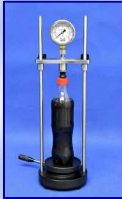
CO 2 Easy con manómetro analógico y termómetro
