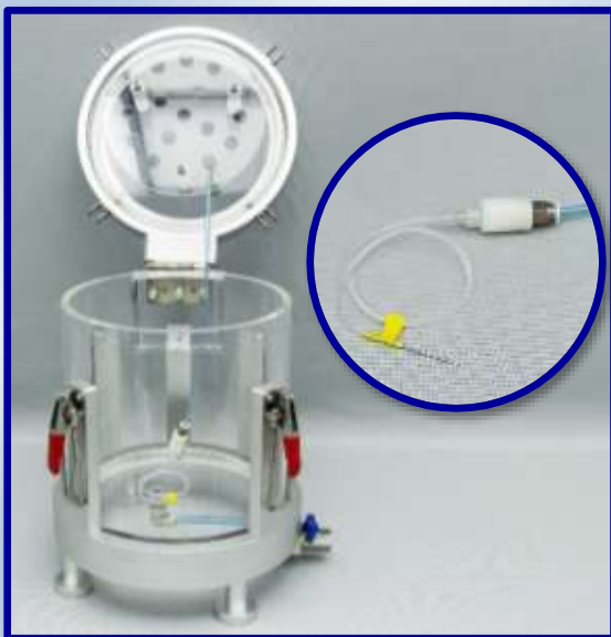
Cámara de vacío y presión positiva con aguja pequeña para perforación
