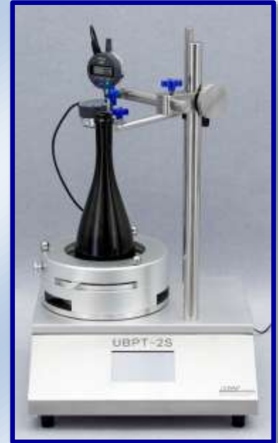
UBPT-2S con 2 cabezales de medición (para la holgura de la boca y la perpendicularidad) y calculadora automática integrada
