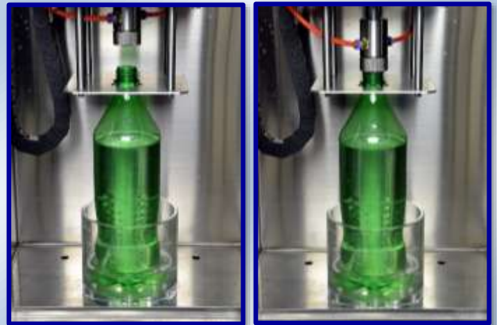
Sistema automático de llenado de agua y solución
